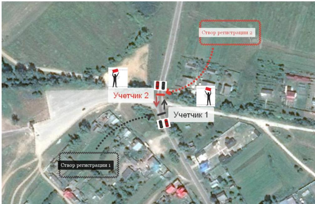
Рисунок 1.2.1 - Расположение «створов регистрации» при учете интенсивности на перегоне.
